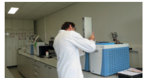
▲ PAK's en PCB's geanalyseerd in OCAS met gaschromatografie-massaspectrometrie (GC-MS)
