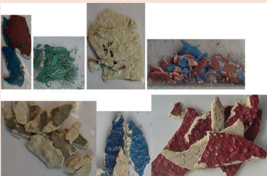
▲ Exemples d'écaillés de revêtements prélevés sur ponts
