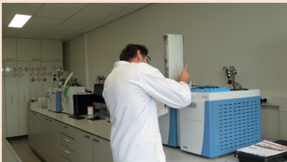
▲ HAP et PCB analysés à OCAS par chromatographie gazeuse - spectrométrie de masse (GC-MS)
