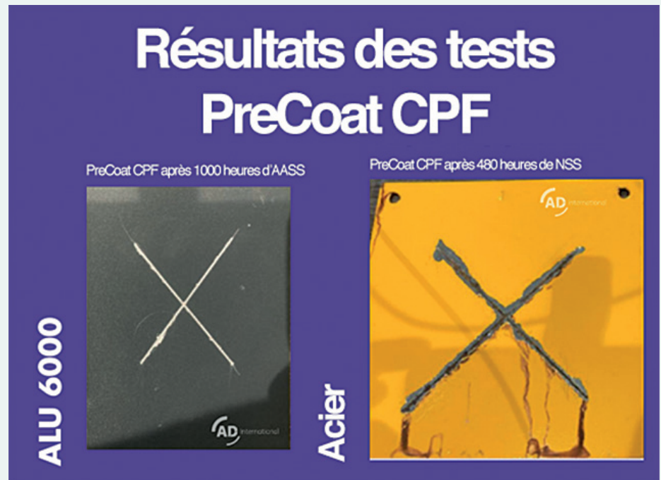
Résultats après 1000 heures d'AASS conformément à la norme DIN EN ISO 9227 effectuée par IFO et 480 heures de NSS sur l'acier.
