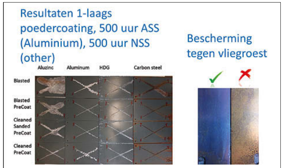
Afbeelding 3: resultaten zoutsprei en bescherming vliegroeest
