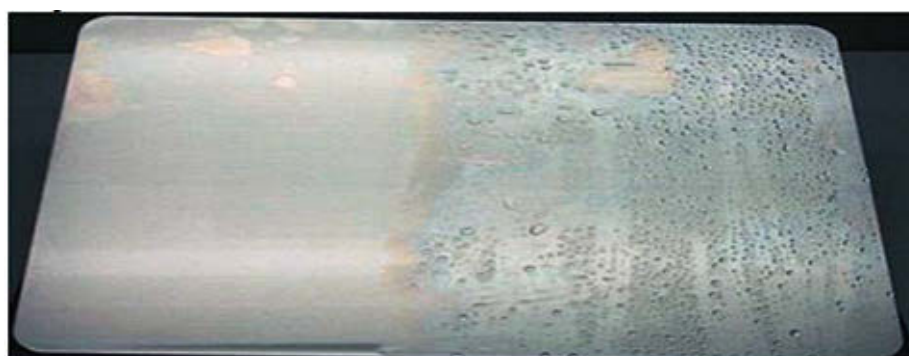
Afbeelding 1: waterbreektest met solventvervanger (links) en oplosmiddel (rechts)
