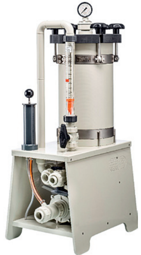
▲ Deze filterinstallatie wordt ingezet op het ontvettingsbad zodat de kwaliteit van de procesvloeistof op een constanter niveau blijft
