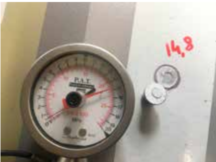
Voorbeeld van een pull-off test
