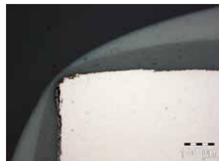
Voorbeeld aan de hand van een micro opname van een doorsnede van een 2 lagen poedercoatsysteem op een scherpe rand. De lagen zijn duidelijk zichtbaar door de verschillende kleuren grijs en de ondergrond is lichtgrijs.
