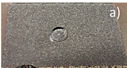
Fig 5: photos d'une goutte d'eau déposée sur: a) une pièce Ti EBM; b) une pièce Ti EBM revêtue par une fine couche de sol gel développée par CRM.
